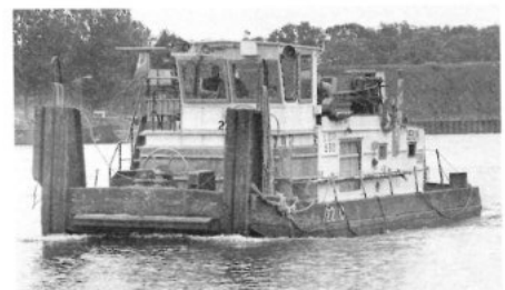
Schubbugsierer 104 kW (140 PS) im Binnenhafen Königs Wusterhausen
