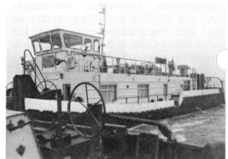
780-PS-Schubschiff, gebaut in der ersten Hälfte der 70er Jahre, Doppelschrauber mit drehbaren Corddüsen.
