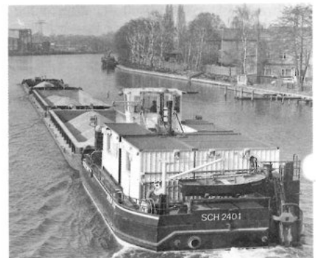
300-PS-Schubschiff (220 kW) in Berlin-Schönneweide (16,5x8,20x1,58 m). Diese Schiffe wurden Mitte der 80er Jahre für die Deutsche Binnenreederei in einer Serie von 34 Stück gebaut. Sie verkehren auch mit vier Schubbehältern
